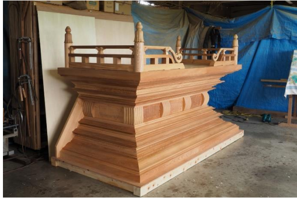
作業所内にて仮組立完了 再度、組外して漆工事になります。
